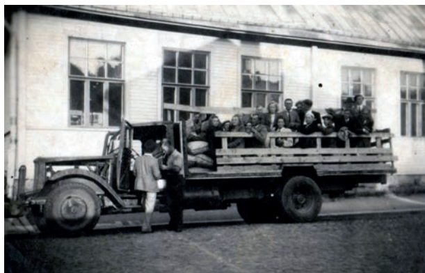
Vuonna 1948 Suomessa oli vielä pula-aika. Silti Juurikan kylän väki lähti Huikkolan Simo Vottosen kyydillä Kolille. Kuten näkyy, voimanlähteenä oli hääpönttö. Puukaasun tuottamiseen tarvittiin runsaasti hiiliä. Niitä näkyy säkitettyinä auton ohjaamon takana. Kuva otettiin lähtötilanteessa Juurikan koulun pihalla.
